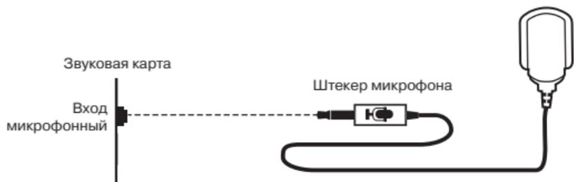
Рис. 1. Схема подключения
